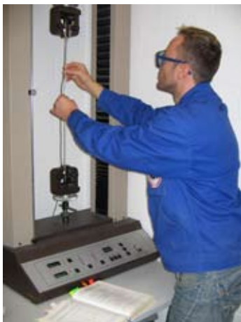
MFA im Zugversuch; selbst nach fünffacher Dehnung der Probe kommt es noch nicht zum Bruch - Foto: HwK Koblenz
