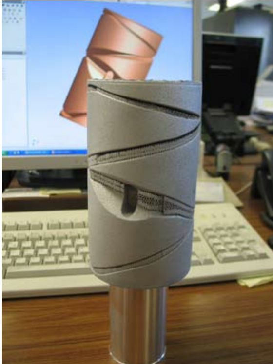
SLM-Rohling, aufgebaut aus AISi10 - Quelle: MELOTTE N.V.
