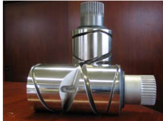
Hintere Nutenwalze: Aufgebaut mit dem SLM-Verfahren, poliert und Ni-beschichtet Vordere Nutenwalze: Hergestellt mit dem Thixomolding-Verfahren in AZ91D, Ni-beschichtet Quelle: MELOTTE N.V.
