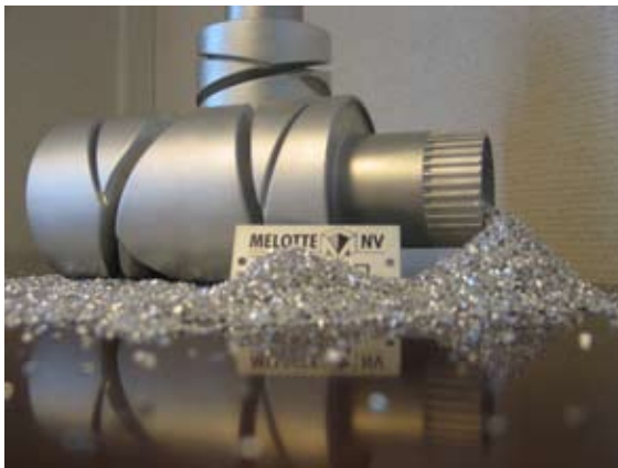
Beim Thixomolding wird Magnesium in Form von kleinen Chips verarbeitet - Quelle: MELOTTE N.V.
