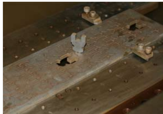
Präzise: Der Wasserstrahl arbeitet inzwischen bis auf \pm 0,02 mm genau - Quelle: DKW GmbH
