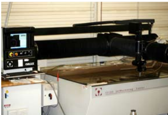
Leise und dabei sehr präzise arbeitet die neueste Generation der Omax-Wasserstrahlanlagen - das Unterwasserschneiden macht's möglich. - Quelle: DKW GmbH
